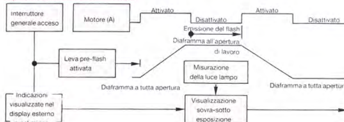
Sequenza operativa della funzione flashmeter
