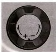
Anello di compensazione dell'esposizione
