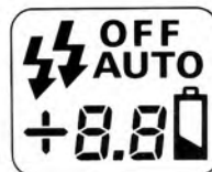
Display LCD Visualizza modo flash, valore di compensazione dell'esposizione e check batteria.
