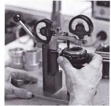
Centatura delle etichette su obiettivo Zeiss. La verifica di collimazione e di accoppiamento obiettivo-camera viene eseguita con particolare severità ogni qual volta si effettui un intervento sulla parte ottica.
