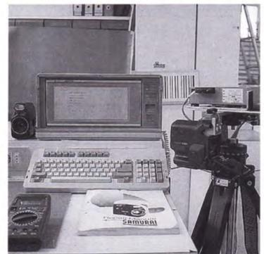
Le moderne Reflex Autofocus vengono misurate e tarate elettronicamente tramite computer che svolge un programma di prove.
