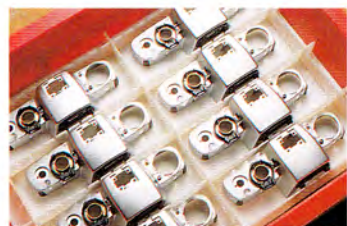
Solide calotte in pressofusione di zinco, cromate secondo un processo esclusivo Leica.
