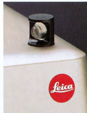
La cellula di ricezione IR, rientrante e ruotabile per una migliore ricezione.
