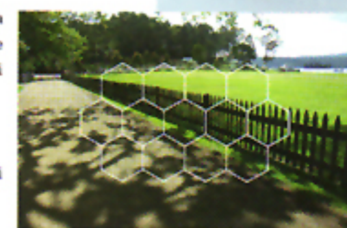
Misurazione a 14 segmenti con schema a nido d'ape
