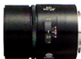
AF 2.8 105 mm Messa a fuoco minima: 1 m Diametro del filtro: Ø 65 mm Dimensioni: 69,5 Ø x 83 mm Peso: 365 g
