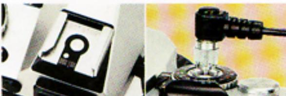
**Slitta a contatto sincro diretto:** La slitta posta alla sommità dell'apparecchio consente la connessione diretta di un lampeggiatore elettronico. Montando gli Auto-Electroflash serie X, essi predispongono automaticamente il tempo di sincronizzazione X ( $1/125$ ). E' anche previsto un terminale per cavetto PC.
