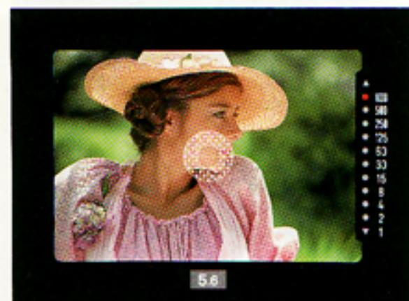
Il controllo a priorità dei diaframmi vi permette di dominare la profondità di campo con estrema precisione, pur sfruttando i vantaggi di un'esposizione automaticamente esatta. Basta portare il selettore di modo su «A» e scegliere il valore di diaframma che produrrà la voluta area di nitidezza sia davanti sia dietro il soggetto. I diaframmi più chiusi produrranno la maggiore profondità di campo, la quale si ridurrà aprendo maggiormente il diaframma.
