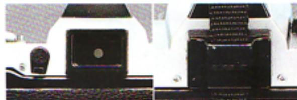
**Oscuratore del mirino:** L'oscuratore del mirino incorporato nella XD-7 impedisce l'ingresso della luce nell'oculare, il che potrebbe interferire con la misurazione.
