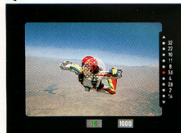
Quando il tempo di esposizione è più importante per la vostra immagine, basterà che spostiate il selettore di modo su «S». Potrete così scegliere il tempo di esposizione che volete e l'apparecchio regolerà automaticamente il diaframma per l'esatta esposizione. Sia che vogliate «congelare» l'azione, sia che vogliate enfatizzarla con un «mosso» intenzionale, il modo a priorità dei tempi vi faciliterà il raggiungimento del vostro obiettivo di creatività.
