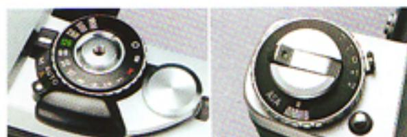
**Leva di avanzamento/Pulsante di scatto elettromagnetico:** La leva di avanzamento è morbidissima. Ha una corsa impegnata di 130° con una corsa morta di presa di 30°, il pulsante di scatto elettromagnetico è eccezionalmente silenzioso ed esente da vibrazioni.
