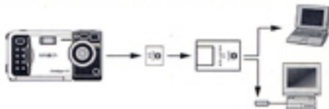
Inserite la scheda Compact Flash nell'Adattatore scheda per PC, accessorio opzionale, ed inseritelo nello slot per schede incorporato nel PC o nel lettore di schede collegato al PC. In questo caso è possibile leggere, scrivere, cancellare, aggiungere dati sull'immagine come se si stesse utilizzando l'hard disk.
