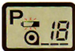
La macchina fotografica controlla automaticamente lo stato di carica della batteria segnalandovi quando essa è in via di esaurimento.
