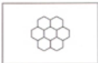
Il sistema di misurazione con schema a nido d'ape permette di effettuare automaticamente la misurazione e la valutazione delle condizioni di luce tramite 7 diversi segmenti uniformi (più quello dello sfondo), garantendo sempre la più precisa e ben bilanciata esposizione.
