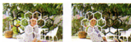
La MISURAZIONE CON SCHEMA A NIDO D'APE rende possibile valutare i livelli di luce tramite 14 fonti indipendenti.
