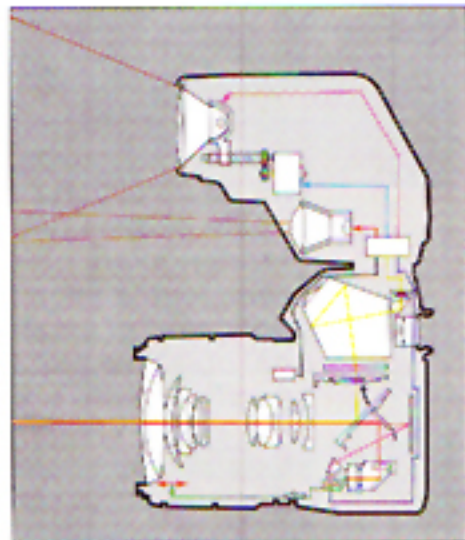
Misurazione automatica diretta TTL con flash
