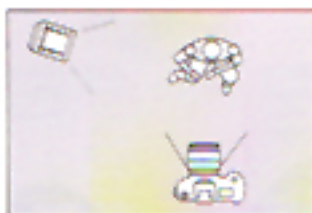
Il Flash a Programma 5400HS garantisce i 2/3 dell'illuminazione necessaria per una corretta esposizione; il rimanente 1/3 è fornito dal flash incorporato della Dynax 700si.
