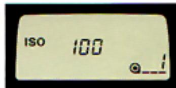
Con le pellicole DX, la sensibilità ISO viene impostata automaticamente. Potrete anche impostare le sensibilità manualmente o modificare l'impostazione DX.
