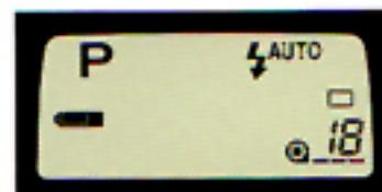
Quando portate l'interruttore principale in posizione «ON», la fotocamera controlla automaticamente la carica della batteria.
