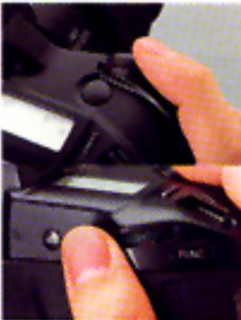
Due selettori facilmente accessibili vi consentono di controllare con la punta delle dita (indice e pollice) profondità di campo e movimento del soggetto.
