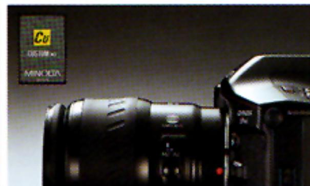
Lo speciale sistema Minolta di attivazione automatica con lo sguardo «Eye-Start» vi garantisce tempi di reazione senza precedenti. Un sensore nell'impugnatura della Dynax 9xi attiva un trasmettitore/ricevitore agli infrarossi situato sotto l'oculare del mirino quando impugnate la fotocamera. Questo attiva i sistemi AF ed AE non appena la fotocamera viene portata davanti al vostro occhio. E finché guarderete nel mirino, la Dynax 9xi sarà istantaneamente pronta per l'uso.
