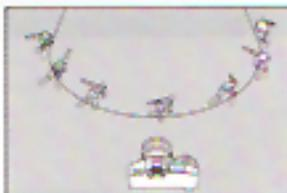
Il sistema di messa a fuoco multi-direzionale di tipo «predictive» calcola le variazioni nella distanza del soggetto anche durante lo spostamento dello specchio della fotocamera e la chiusura del diaframma di apertura, per garantire una messa a fuoco perfetta fino all'istante dell'esposizione.
