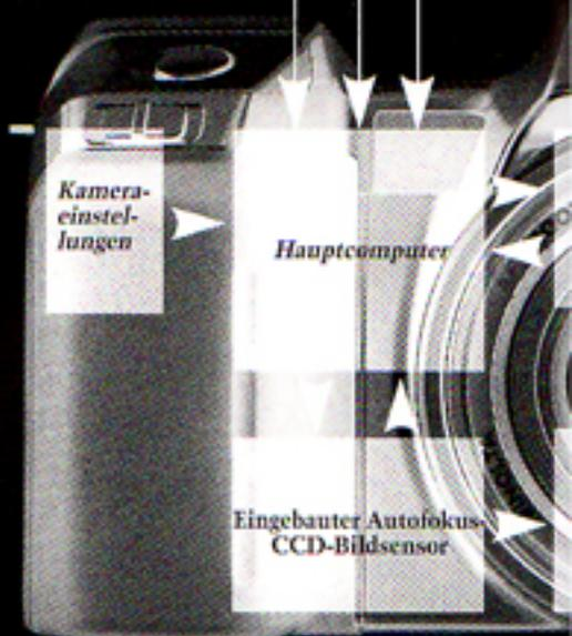
**Programm-Daten:** Bestehend aus Chip-Karten- und Kamerainformationen zur Steuerung der Belichtungs-funktionen im Kameragehäuse.
