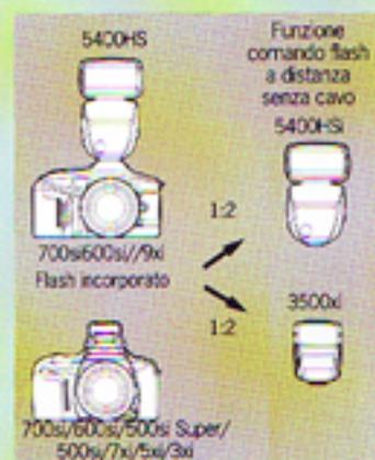
Quando montate l'unità di Comando Flash a distanza senza cavo sulla Dynax 700xi, 600xi o 9xi, (Flash Controller), il controllo del rapporto di luminosità può essere esteso a due o più flash a distanza. Il rapporto di luminosità di due Flash a Programma 5400HS a distanza, o un 3500xi e un 5400HS, può essere impostata manualmente fino a 2:1.
