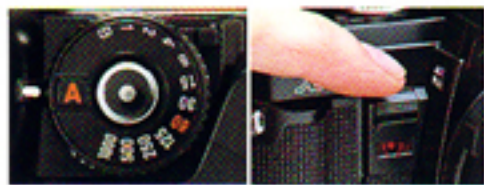
Regolare il selettore dei modi della X-500 su A.
