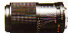
MINOLTA MD ZOOM 75-150 mm f/4 costruzione: 12 lenti in 8 gruppi angolo di visione: 32°-16°30' distanza minima di messa a fuoco: 1,2 m (3,9 ft) diaframma minimo: f/32
