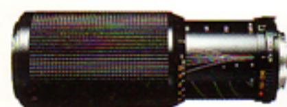
MINOLTA MD ZOOM 100-300 mm f/5.6 costruzione: 13 lenti in 10 gruppi angolo di visione: 24°-8°30' distanza minima di messa a fuoco: 1,5 m (4,9 ft) diaframma minimo: f/32 capacità macro: 1:3,9 della grandezza naturale
