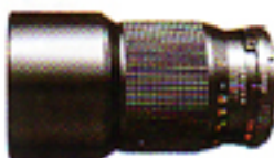
MINOLTA MD 200 mm f/2.8 costruzione: 5 lenti in 5 gruppi angolo di visione: 12°30' distanza minima di messa a fuoco: 1.8 m (6 ft) diaframma minimo: f/32
