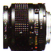
MINOLTA MD MACRO 50 mm f/3.5 costruzione: 5 lenti in 4 gruppi angolo di visione: 47° distanza minima di messa a fuoco: 0,23 m (9 in.) diaframma minimo: f/22
