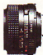
MINOLTA MD 24 mm f/2.8 costruzione: 8 lenti in 8 gruppi angolo di visione: 84° distanza minima di messa a fuoco: 0,25 m (0,8 ft) diaframma minimo: f/22
