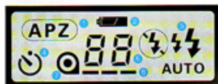
● Indicatore zoom a programma ● Indicatore condizioni batteria ● Indicatore tipo impostazione flash ● Indicatore autoscatto ● Contapose ● Segnali trasporto pellicola ● Simbolo pellicola
