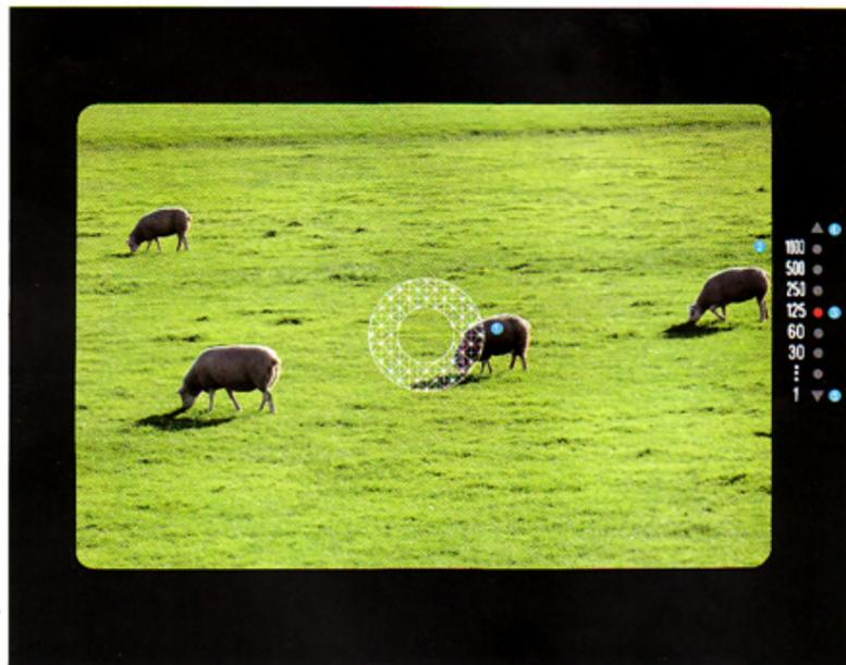
1. Centro di messa a fuoco e spezzatura d'immagine/microprismi.
