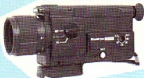
Cinepresa Super 8 muta con obiettivo Sankyo zoom f. 1,2 con messa a fuoco fissa, minima a m 1,5 - Mirino reflex con oculare a regolazione diottrica da meno 5 a più 5 diottrie - Zoom manuale - Velocità 18 fps - Otturatore a 220 gradi per luce disponibile - Esposizione automatica, con segnale di luce insufficiente - Contatore ad azzeramento automatico - Segnale di regolare scorrimento e fine pellicola - Dimensioni 185 x 53 x 101 mm - Peso 500 grammi
