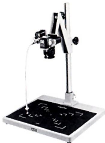
Ein sehr zweckmäßiges Spezialstativ mit maximaler Stabilität für alle makrofotografischen Aufgaben. Dieses Gerät ist besonders empfehlenswert bei flachen und auch bei dreidimensionalen Klein-Objekten. Die Kamera wird an einem verstellbaren Arm festgeschraubt. Die Chromstahlsäule ist 61cm hoch mit einem Durchmesser von 5cm. Die stabile Grundplatte mißt 39,4 × 45cm.
