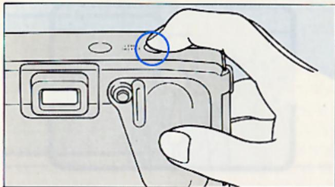
Con l'interruttore posizionato su on, la fotocamera risulta automaticamente impostata sull'uso dell'obiettivo 35 mm. Per utilizzare l'obiettivo 50 mm, premete il pulsante di selezione dell'obiettivo. Premetelo poi di nuovo, per riportare la fotocamera sul 35 mm. L'ingrandimento nel mirino viene regolato automaticamente in modo da mostrare al fotografo la corretta inquadratura per la lunghezza focale usata.
