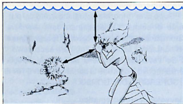
Potete utilizzare la Weathermatic 35DL sott'acqua fino ad una profondità di 5 metri. Al contatto con l'acqua l'apparecchio si trasforma automaticamente da Autofocus in Free-focus (fuoco fisso). La messa a fuoco viene impostata automaticamente, per avere fotografie sempre nitide, quando il soggetto è compreso tra 1,2m e 5m dall'obiettivo 35mm oppure da 1,2m a 3,3m dall'obiettivo 50mm.
