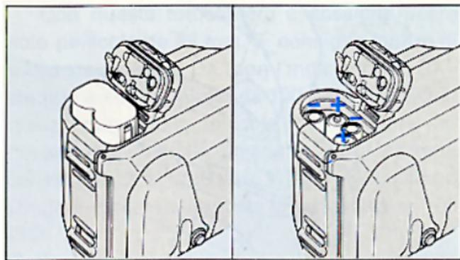
2. Inserite nello scomparto una batteria al litio da 6 V o quattro pile AAA da 1.5 V nel modo indicato, controllando che i contatti + e - siano nella posizione corretta.
