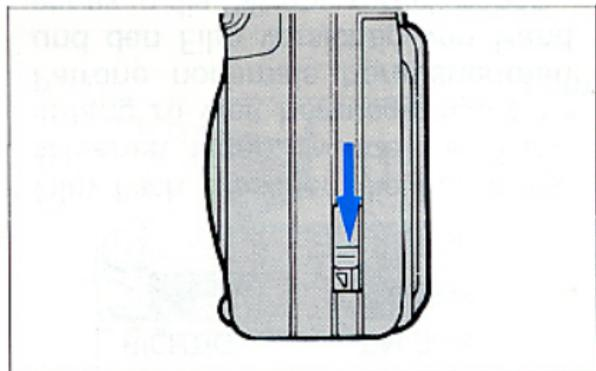
**S**icherstellen, daß das Bildzählwerk auf "0" steht, dann die Rückwand öffnen, indem man die Rückwand-Entriegelung nach unten schiebt.
