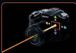
Super SteadyShot rileva e compensa le vibrazioni della fotocamera inclinando il sensore CCD per produrre immagini più nitide e stabili.
