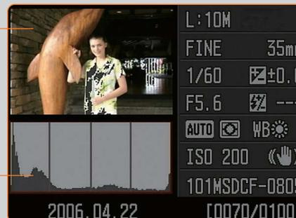
Sia l'immagine che i dati vengono visualizzati contemporaneamente. Ma poiché non c'è testo sull'immagine, è possibile visualizzare al tempo stesso l'istogramma e l'intera immagine, metodo molto efficace per decidere l'esposizione.
