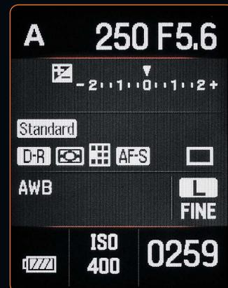
Un solo sguardo al display di navigazione è sufficiente a verificare le impostazioni della fotocamera e i dati di ripresa grazie ai caratteri grandi e all'eccellente leggibilità del testo. La modalità di visualizzazione zoom riporta i dati più importanti; il display, inoltre, passa automaticamente all'orientamento verticale
