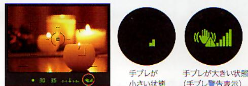
液晶モニター内の手ブレインジケーター表示（α350/α300のみ）
