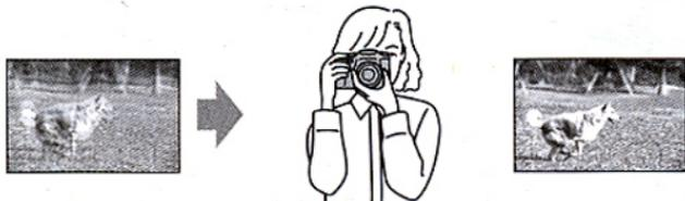
Der Einsatz des Blitzes an dunklen Orten ermöglicht es, selbst schwach beleuchtete Motive hell aufzunehmen, und trägt auch zur Verhütung von Verwackeln bei. Wenn Sie das Umlicht voll ausnutzen wollen, oder falls das Motiv außerhalb der Blitzreichweite liegt, können Sie zur Verringerung der Verwacklungsgefahr die Verschlusszeit verkürzen, ohne den Blitz auszulösen, indem Sie den ISO-Wert erhöhen. (Dies führt jedoch meistens zu körnigen oder verrauschten Bildern.)
