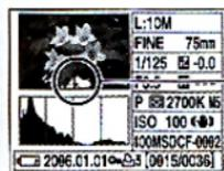
Wenn das Bild einen Highkey- oder Lowkey-Bereich enthält, wird dieser Bereich in der Histogrammanzeige hervorgehoben (Luminanzgrenzwarnung).
