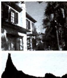
Wenn Sie mit positiv eingestellter Belichtungskorrektur aufnehmen, wird das ganze Bild heller, sodass sich das gesamte Histogramm zur Hell-Seite (rechte Seite) verschiebt. Wenn Sie mit negativ eingestellter Belichtungskorrektur aufnehmen, verschiebt sich das Histogramm zur anderen Seite.
